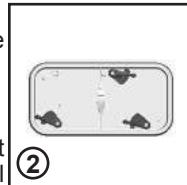
3. Haal de condens-unit uit de machine en haal voorzichtig alle stof of pluizen met een doek weg. Gebruik geen water om de filter schoon te maken
