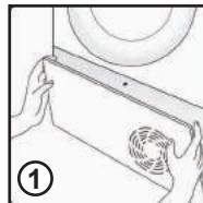
2. Drehen Sie die zwei Verschlusshebel gegen den Uhrzeigersinn und ziehen Sie den Kondensatordeckel heraus.
