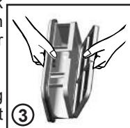
4. Verwijder voorzichtig de spons van zijn plaat en was hem daarna door hem onder een stromende kraan te houden en hem zo te draaien dat alle stof of pluizen verwijderd worden
